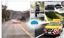
パトロール車両に搭載したカメラからのリアルタイム映像をAIにより処理し、舗装の損傷を自動検知
